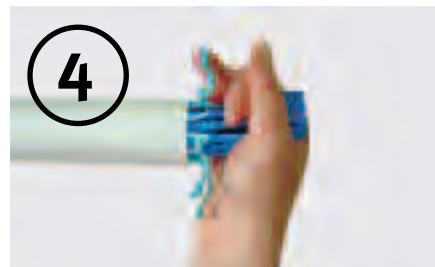
Introduire le thermomètre en maintenant les bras de l'appendice S rassemblés dans une main
