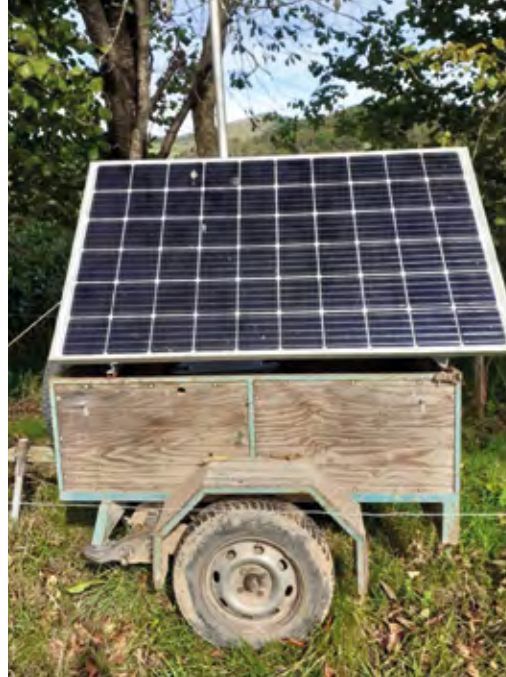
Le contrôleur du SenseHub est alimenté par l'intermédiaire d'un panneau photovoltaïque monté sur une remorque pour faciliter le transport.
